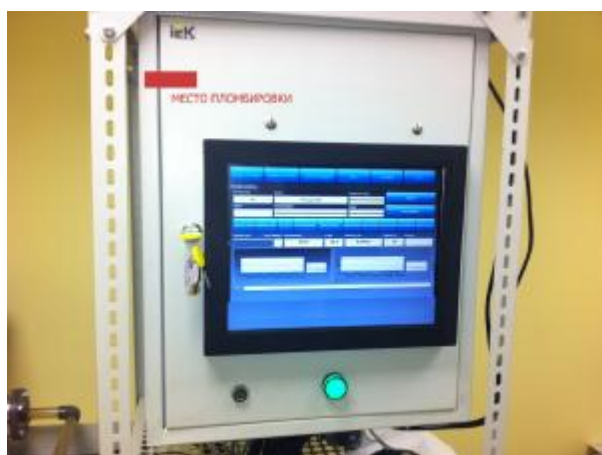
Фото 2. Обозначение места для нанесения поверительного клейма в виде наклейки.
